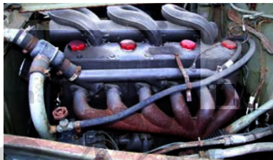
Po desetih letih licenčne proizvodnje so izdelali lasten 8-litrski motor FAMOS F z močjo 96 kW (130 KM), ki so ga kasneje 'povrtali' na 8,3 litra in mu povečali moč.
