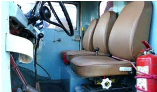
Kasnejši modeli so imeli mehansko vzmeten vozniški sedež in ločena sopotniška sedeža.
